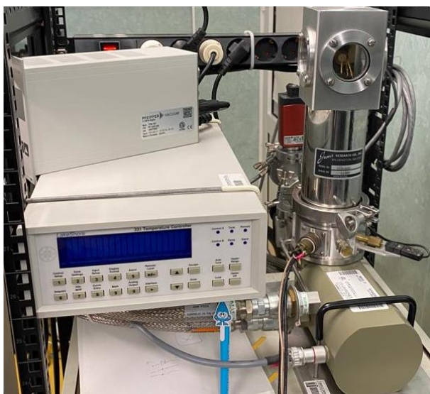
Fig. 1.1 Ansamblu de caracterizare la temperaturi joase pentru diodele Schottky pe SiC.
